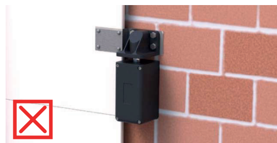
De grendel NIET opwaarts verticaal monteren.
