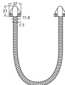
DL10MW 10 mètres de tuyau flexible blanc
