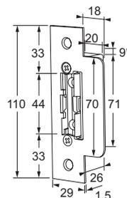
**À rupture de courant = déverrouillé hors tension**
