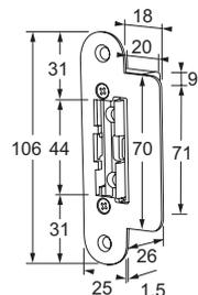
**À rupture de courant = déverrouillé hors tension**
