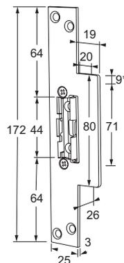
**À rupture de courant = déverrouillé hors tension**
