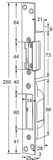
**À rupture de courant = déverrouillé hors tension**
